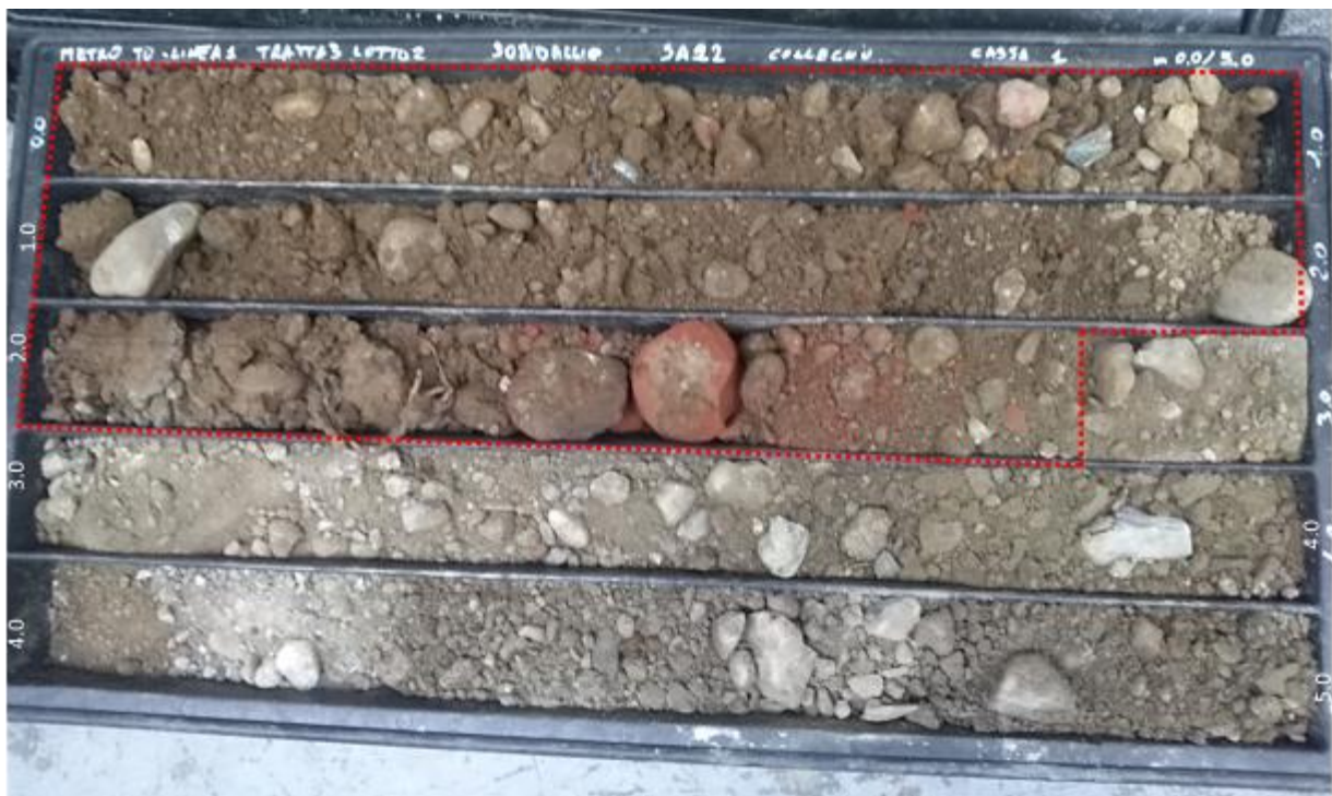
Figura 7: Carote estratte dal sondaggio a carotaggio continuo SA12, in prossimità della fine della tratta ad est (PK 1+800 circa). I materiali di riporto sono contornati in rosso, è stato individuato a 2.9 m dal p.c..
