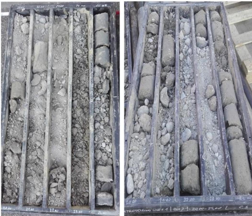
Figura 20: Sondaggi BH4 (a sinistra) e BH7 (a destra), dettaglio carote tra i 20 e 25 metri di profondità dal p.c.; si individuano presenti livelli di spessore da decimetrico fino a metrico particolarmente addensati.
