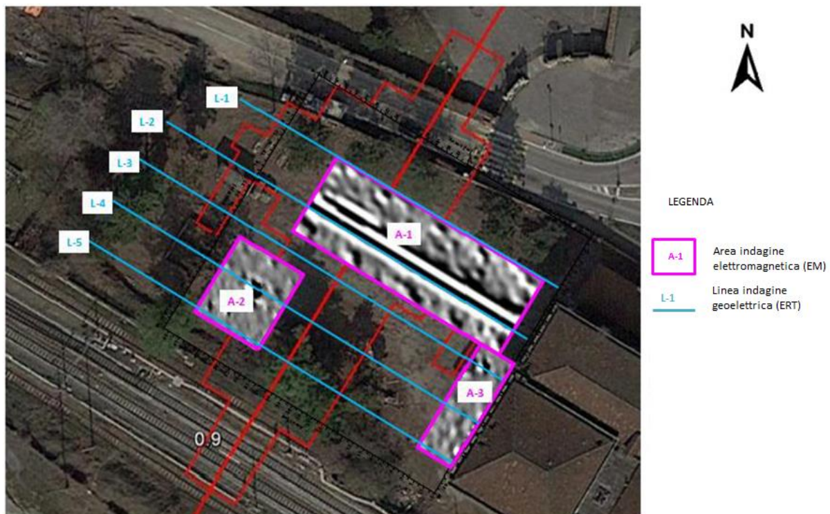
Figura 16: Campo prova indagini geofisiche in Certosa, area FERSERVIZI.
