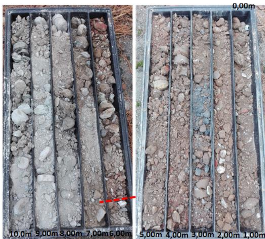
Figura 19: Cassette catalogatrice BH2. La linea rossa indica il limite UG0-UG1.
