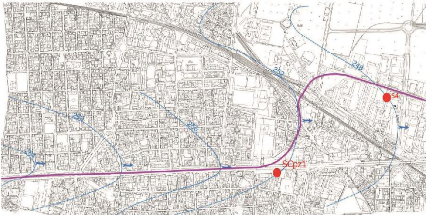
**Figura 9:** Stralcio della planimetria con evidenziate in blu le linee isopiezometriche ed in rosso l'ubicazione dei piezometri SCpz1, installato in fase di progetto definitivo, e S4.
