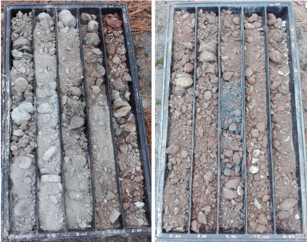
**Figura 7:** Carote estratte dal sondaggio a carotaggio continuo BH2 presso la Stazione Certosa. Il limite dei materiali di riporto con i depositi naturali, evidenziato in rosso, è stato individuato a 5,9 m dal p.c..
