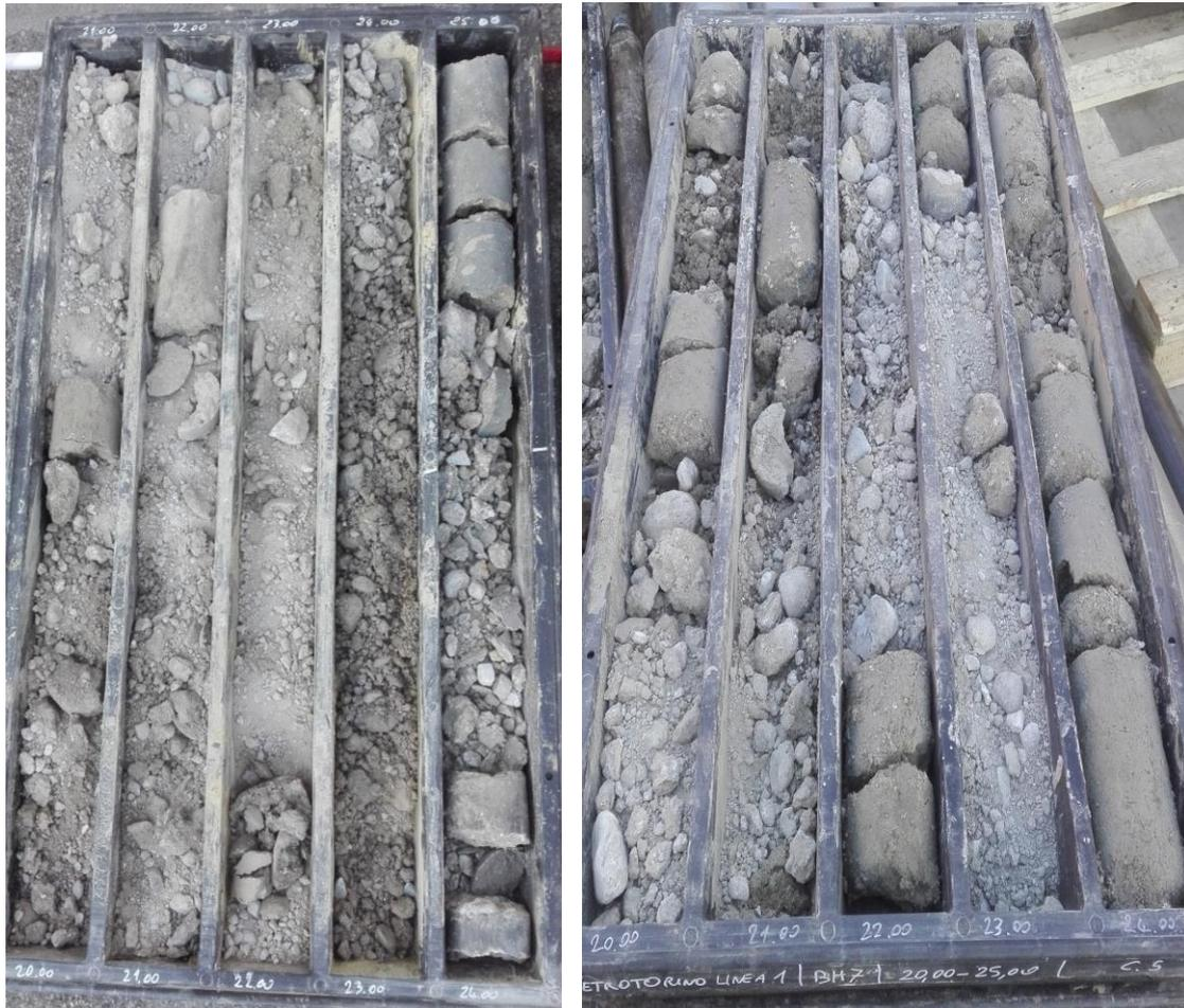
**Figura 8** – Fotografie delle carote dei sondaggi BH4 (a sinistra) e BH7 (a destra), estratte tra i 20 metri e i 25 metri di profondità dal p.c. lungo c.so Francia; sono presenti livelli di spessore da decimetrico fino a metrico particolarmente addensati.
