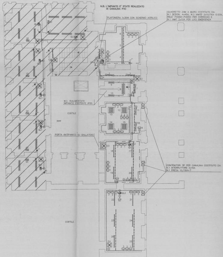
N.B.: ALL'INTERNO DEI LOCALI INDICATI CON TRATTEGGIO L'IMPIANTO ELETTRICO NON E' STATO REALIZZATO
