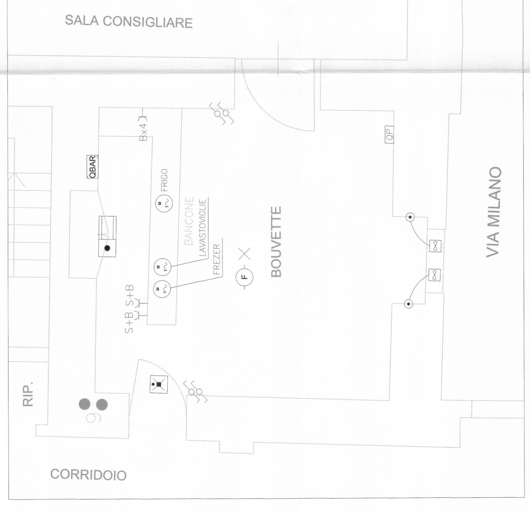
ZONA OGGETTO DI INTERVENTO PIANO SECONDO LOCALE BOUVETTE: RIFACIMENTO QUADRO E IMPIANTO FORZA MOTTRICE.
