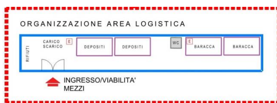
Organizzazione area logistica di cantiere
