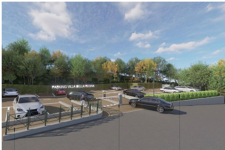
RINGHIERA PARAPETTO REALIZZATA IN TUBOLARE DI ACCIAIO ZINCATO VERNICIATO A POLVERE COME MODELLO CITTA' DI TORINO
