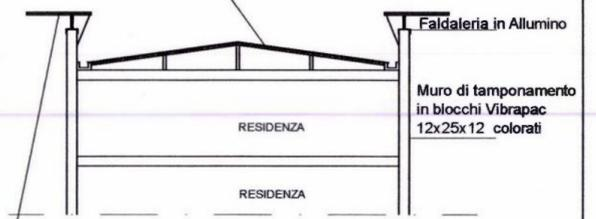
Tettuccio con struttura in acciaio zincato verniciato colore grigio + vetro ASF "azzurro" fissato a mensole idem c.s. interasse 2,00 mt circa
