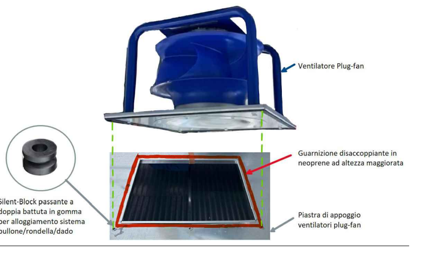
DETTAGLIO FISSAGGIO VENTILATORI
