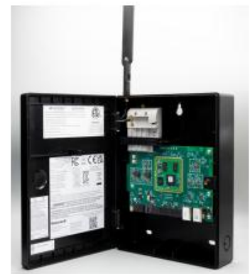
Gateway CLSS con Modulo Cellulare Dual SIM
