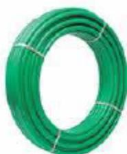
**Tubo MULTI-CALOR ISOLINE, PE-X/Al/PE-X, PN 10 - 95°C, con isolante termico  $\lambda$  0,040, a norma 10/91, in rotoli, colore verde**
