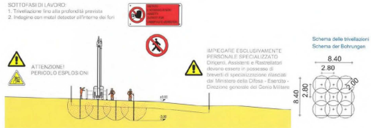
Modalità di intervento per l'esecuzione della bonifica profonda.
