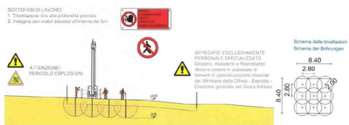
Modalità di intervento per l'esecuzione della bonifica profonda.
