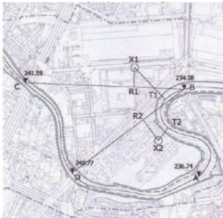
Grafico 4: Esempio di applicazione del calcolo per la determinazione della quota di riferimento in un caso che dà luogo a risultati contraddittori.
