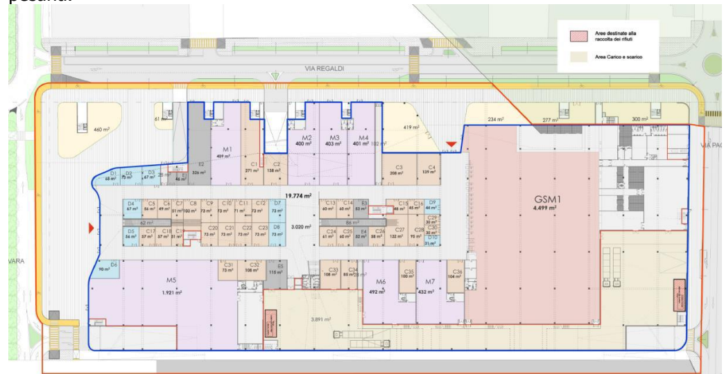
Fig: Pianta del piano terra con indicazione delle aree dedicate al carico/scarico merci e alla raccolta dei rifiuti (Fonte: Verifica previsionale di Impatto acustico)
