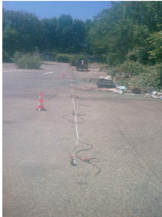
Foto 05 – Stendimento della base sismica MASW – L3
