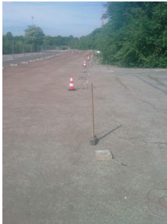
Foto 01 – Stendimento della base sismica MASW - L1
