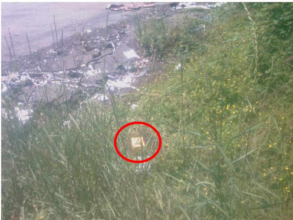
Foto 06 – Nel cerchio rosso l'ubicazione del tromino per la misurazione della frequenza di risonanza caratteristica del sito L3
