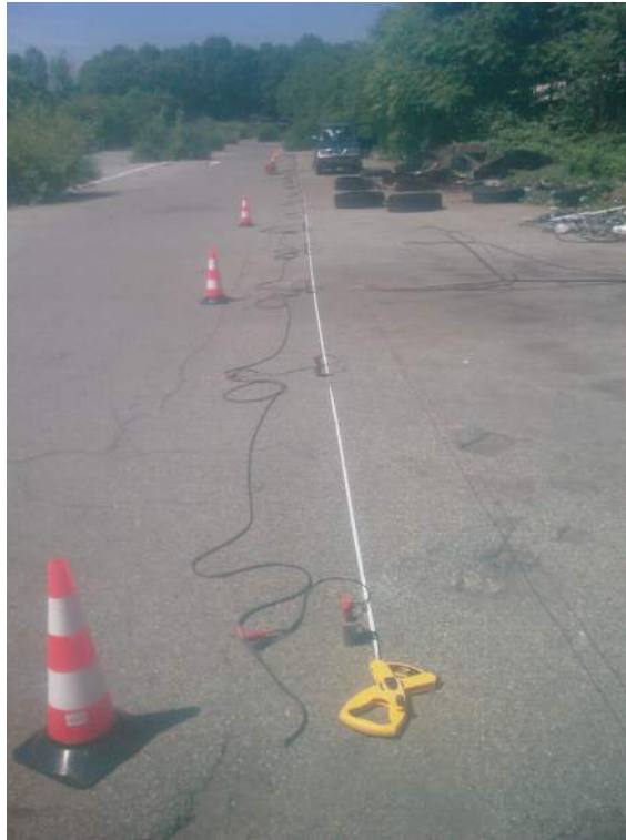
Foto 03 – Stendimento della base sismica MASW – L2
