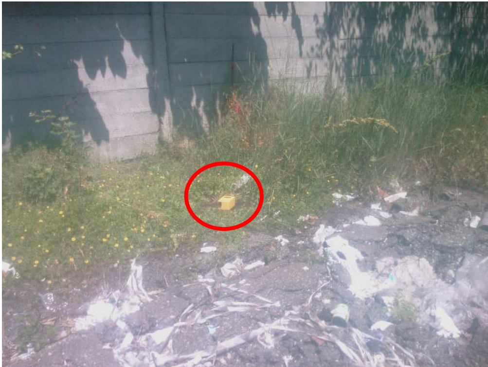
Foto 04 – Nel cerchio rosso l'ubicazione del tromino per la misurazione della frequenza di risonanza caratteristica del sito L2
