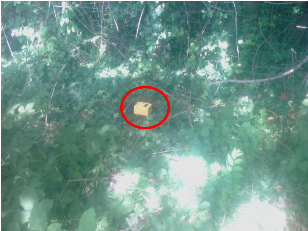
Foto 02 – Nel cerchio rosso l'ubicazione del tromino per la misurazione della frequenza di risonanza caratteristica del sito L1
