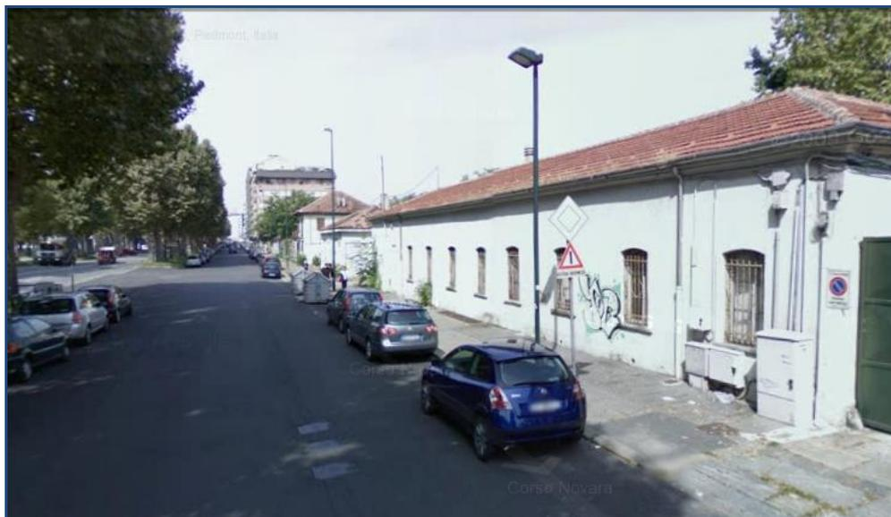
Nella sezione stradale esistente del controviale di C.so Novara, la linea presenta pali non a sbraccio con interasse di 20 m, disposti su un lato della carreggiata, a filo marciapiede.
