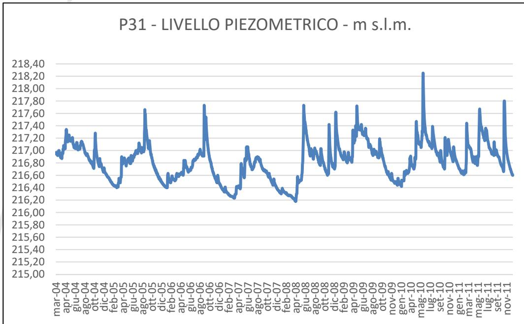
**Figura n** – Andamento del livello piezometrico relativo alla falda superficiale nel piezometro P31 (Rete di monitoraggio delle acque sotterranee della Regione Piemonte - Direzione Pianificazione Risorse idriche sotterranee)
