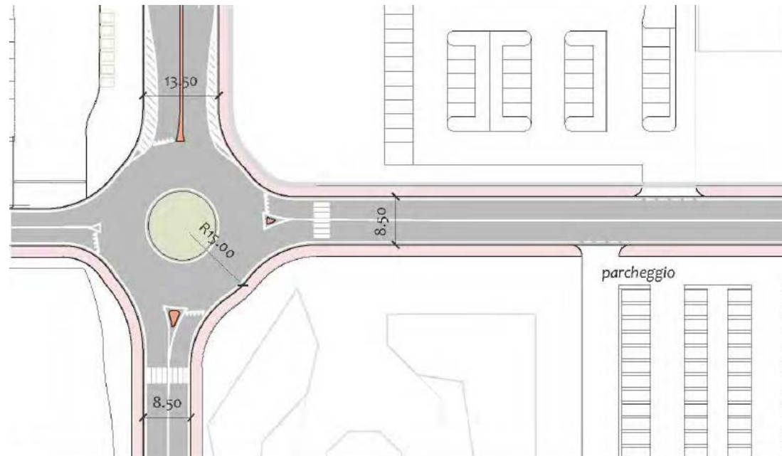
Figura 40 – Rotatoria interna asse perimetrale ovest
