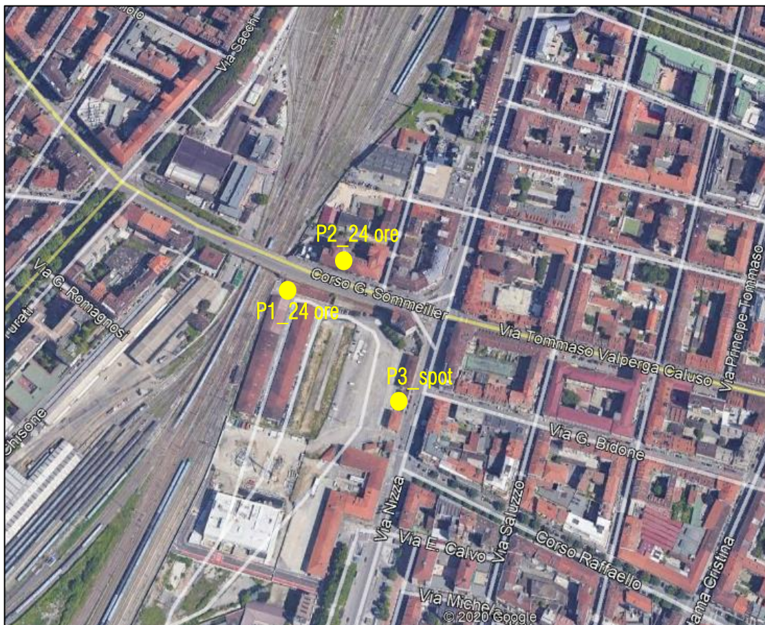
Figura 23 – Localizzazione postazioni di misura
