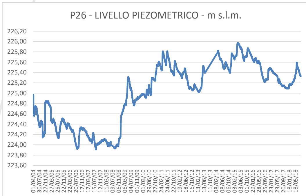
Figura i – Andamento del livello piezometrico relativo alla falda superficiale nel piezometro P26 (Rete di monitoraggio delle acque sotterranee della Regione Piemonte - Direzione Pianificazione Risorse idriche sotterranee)
