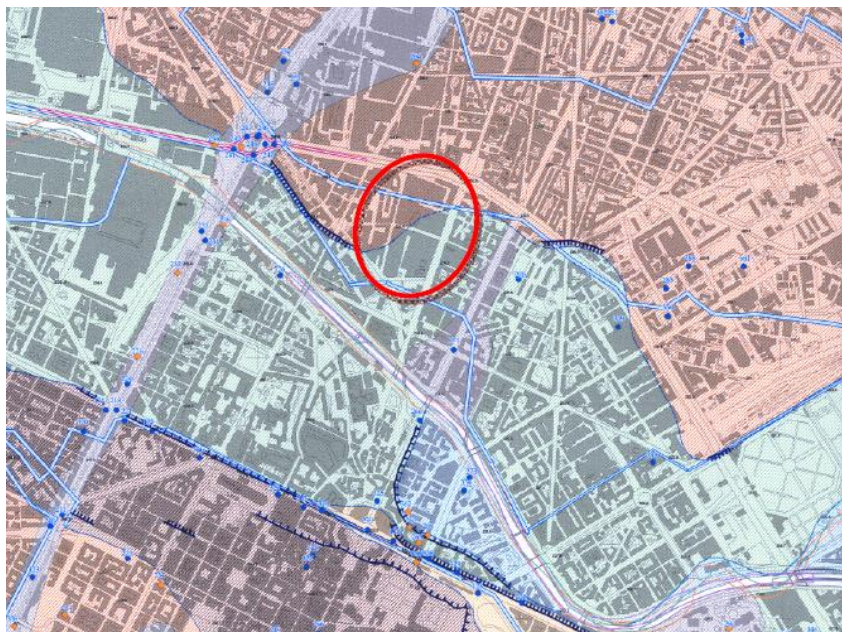
Unità distinte in base al bacino di provenienza (successioni di depositi fluviali e fluvio-glaciali)
