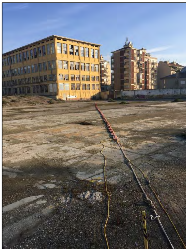
Figura 2 – Stendimento mobile per acquisizione di dati sismici per onde di superficie utilizzato
