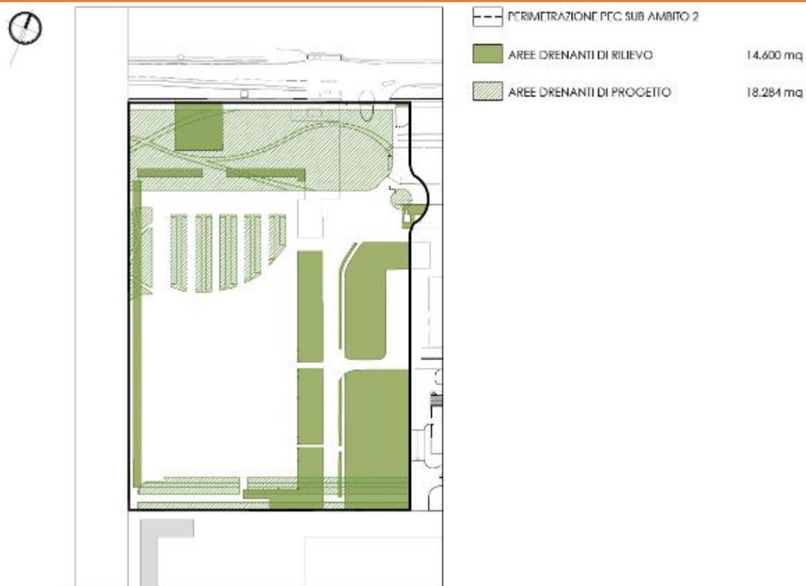
Figura 66: Planimetria dello stato di fatto con il confronto delle aree drenanti esistenti e di progetto (Elaborazione Studio 421)
