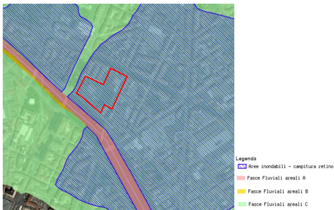
Figura 4.3: Estratto fasce pericolosità idraulica PAI – Fonte Geoportale AIPO (in rosso l'area di intervento)
