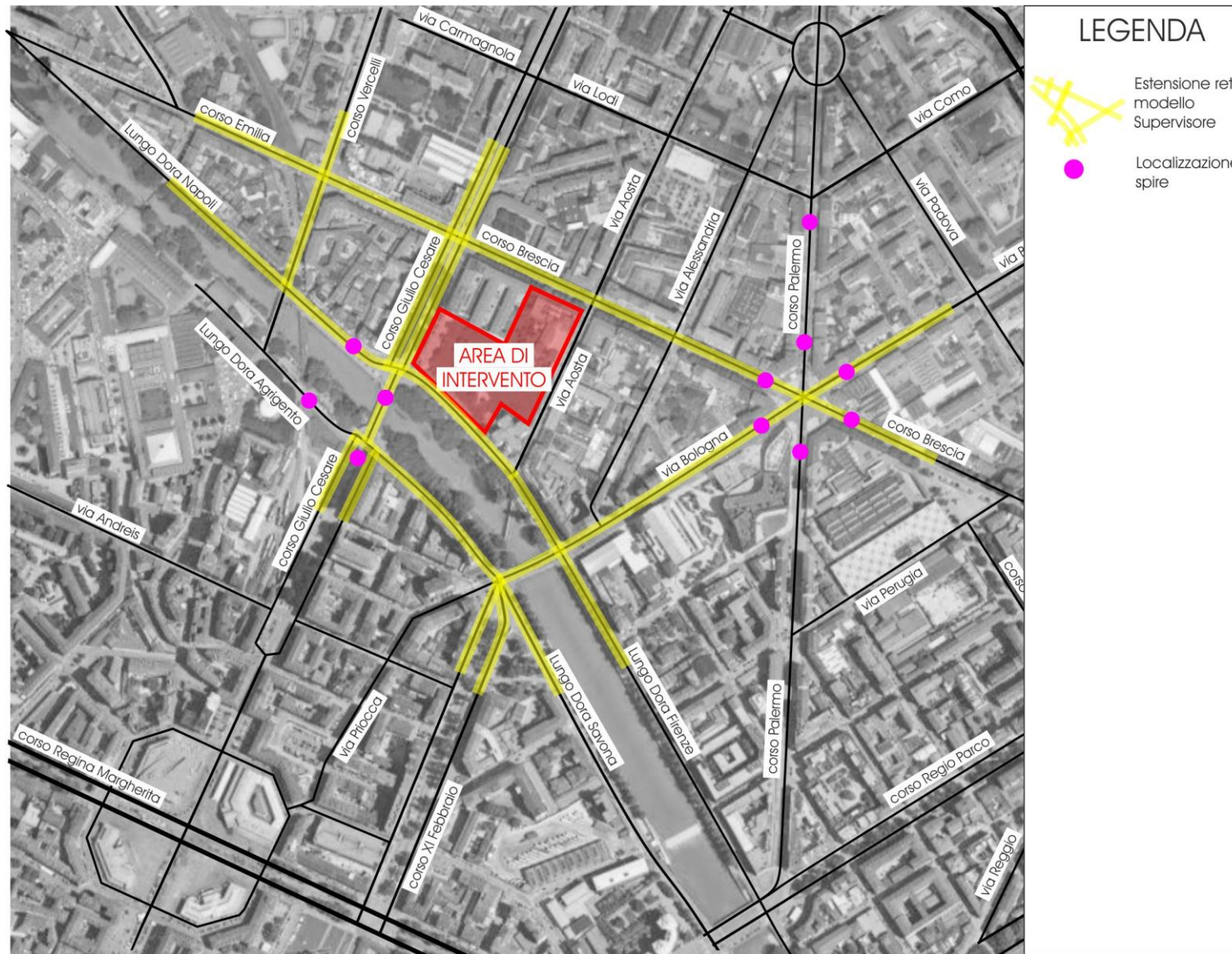
Figura 22 – Estensione rete modello “Supervisore” e localizzazione spire di conteggio veicoli
