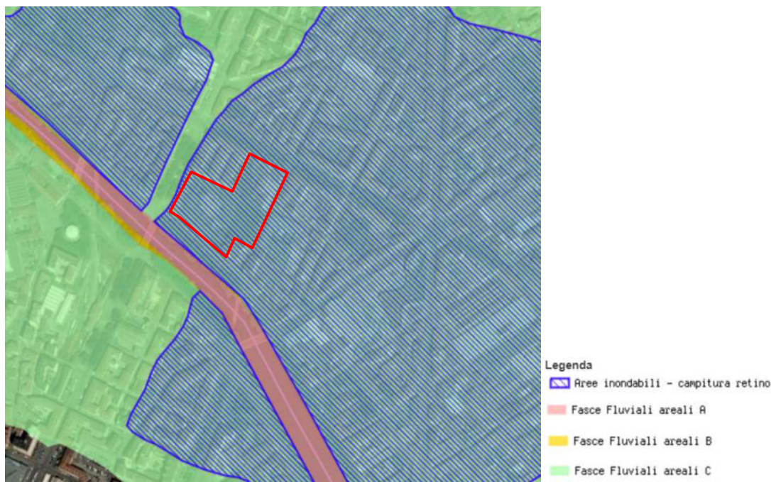
Figura 3.17: Estratto fasce pericolosità idraulica PAI – Fonte Geoportale AIPO (in rosso l'area di intervento)
