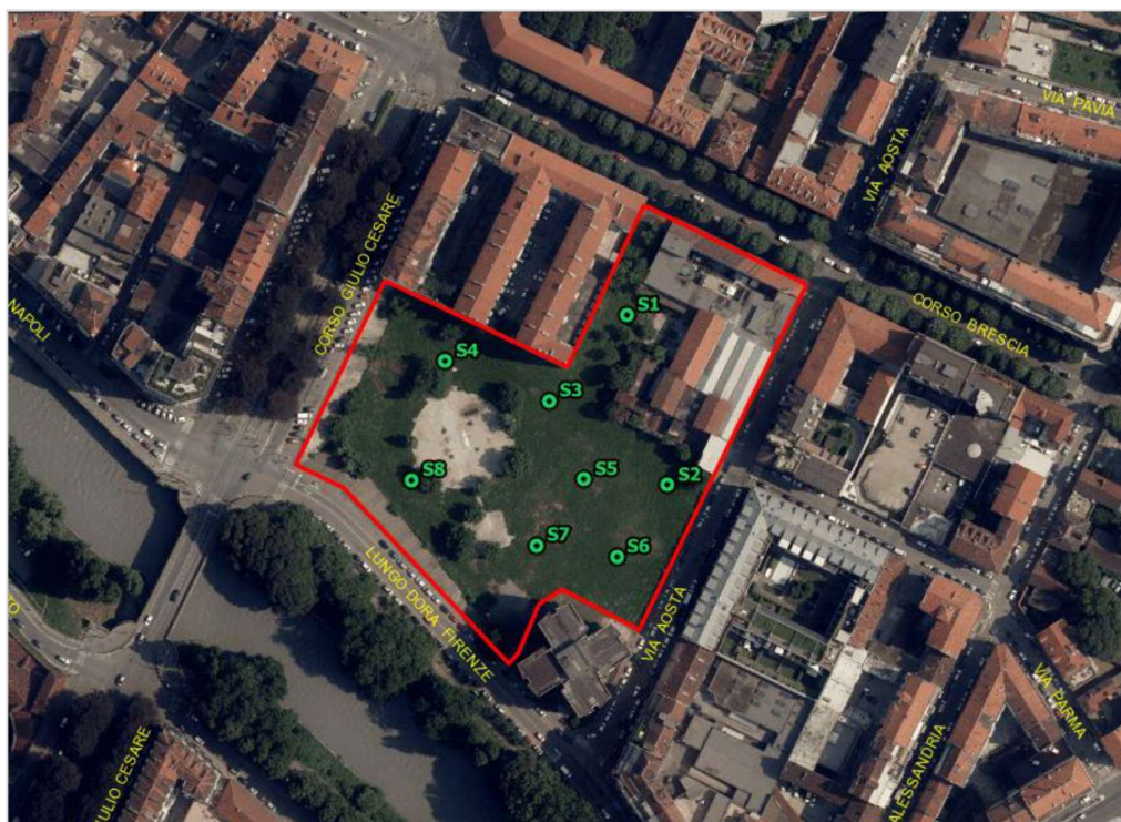
Figura 2.10: Ubicazione dei sondaggi geognostici
