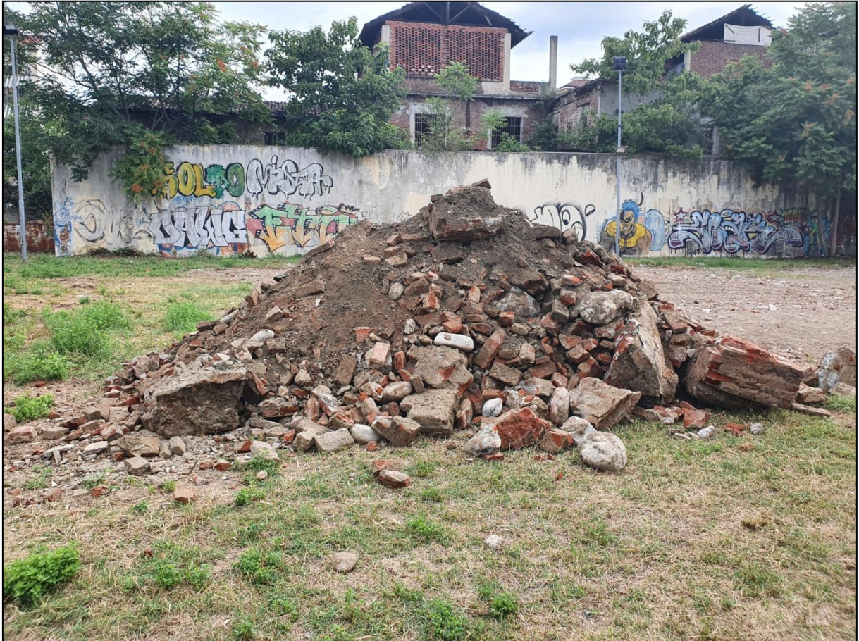
Figura 7 - Blocchi di CLS, manufatti residuali in mattoni e ciottoli decimetrici di origine naturale
