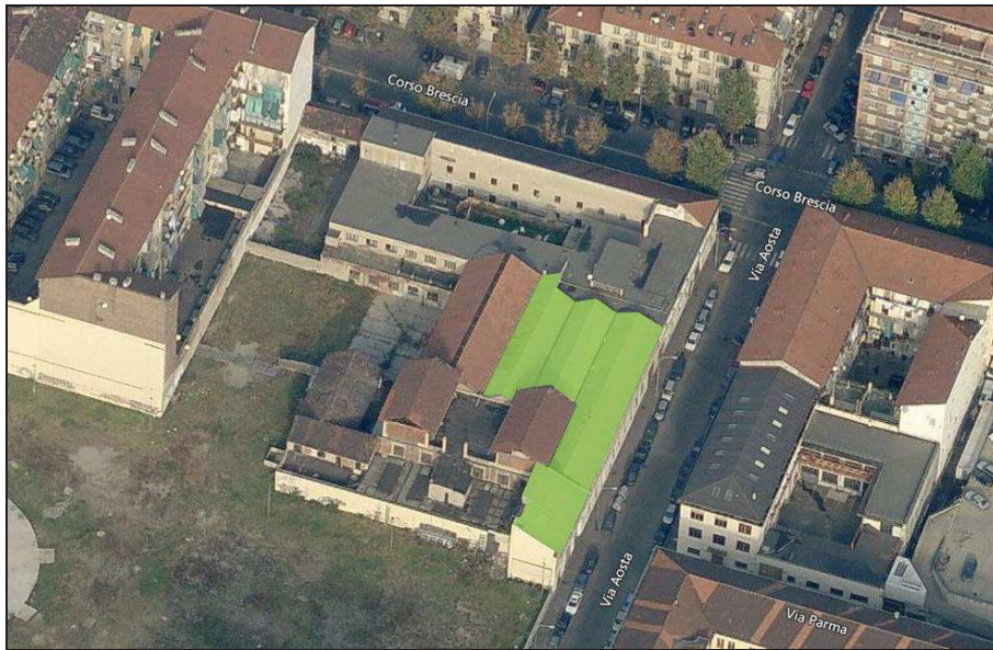
Figura 5 - Indicazione su foto aerea delle coperture in cemento amianto (in verde)
