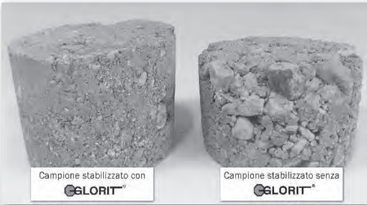
Confronto fra provini dopo aver effettuato il test di gelività. A sinistra provino con GGLORIT®, a destra provino senza GGLORIT®.
