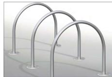
Portatubi in acciaio spazzolato, formato da tubolare calandrato che forma un arco a tutto sesto (R = 50cm). E' dotato di due piastre circolari ammassate e forate per favorevole fissaggio a terra con tasselli. Di norma le due estremità dell'arco vengono inghissate a terra in un pilino in cls.
