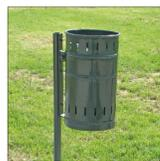
Cestino portatili con palo integralmente in acciaio, contenitore cilindrico in lamiera stampata, forata e nervata con estremità ribordate antitaglio, montato su supporto in tubolare di acciaio di diametro 4cm.
