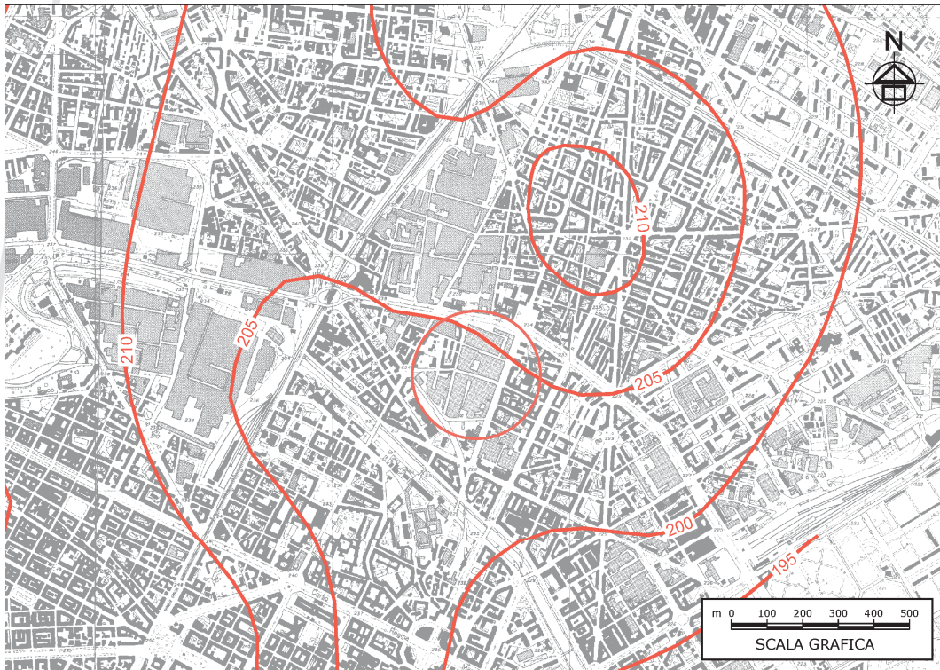
Figura f – Estratto dalla Carta di base dell'acquifero superficiale (fonte DGR 3 giugno 2009, n. 34-11524, aggiornata con DD 4 agosto 2011 n. 267 e DD 3 dicembre 2012 n. 900)
