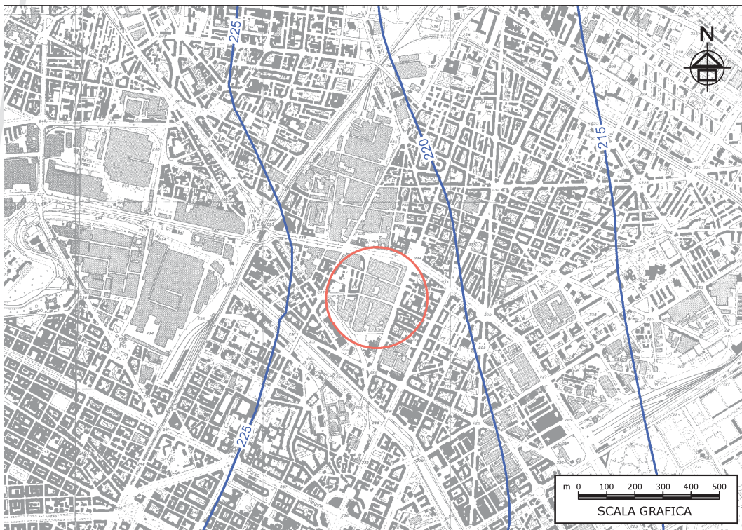
Figura e - Estratto dalla Carta della superficie piezometrica (banca dati Regione Piemonte)
