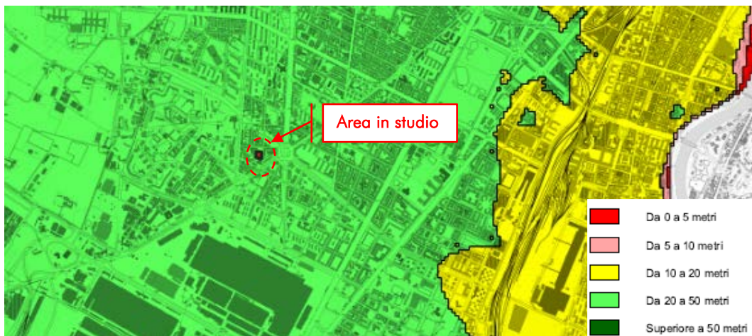
Fig. 2.11 Stralcio della "Carta della soggiacenza della falda idrica a superficie libera relativa al territorio di pianura della Regione Piemonte alla scala 1:250.000"
