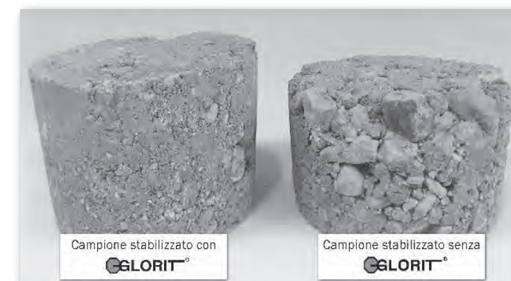
Confronto fra provini dopo aver effettuato il test di gelività. A sinistra provino con GLORIT®, a destra provino senza GLORIT®.
