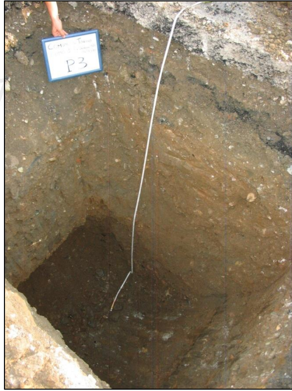
Pozzetto esplorativo P3.
