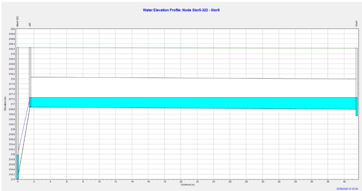
Figura 20: massimo riempimento delle condotte per evento intenso e di breve durata (picco a 10 minuti) TR50 anni
