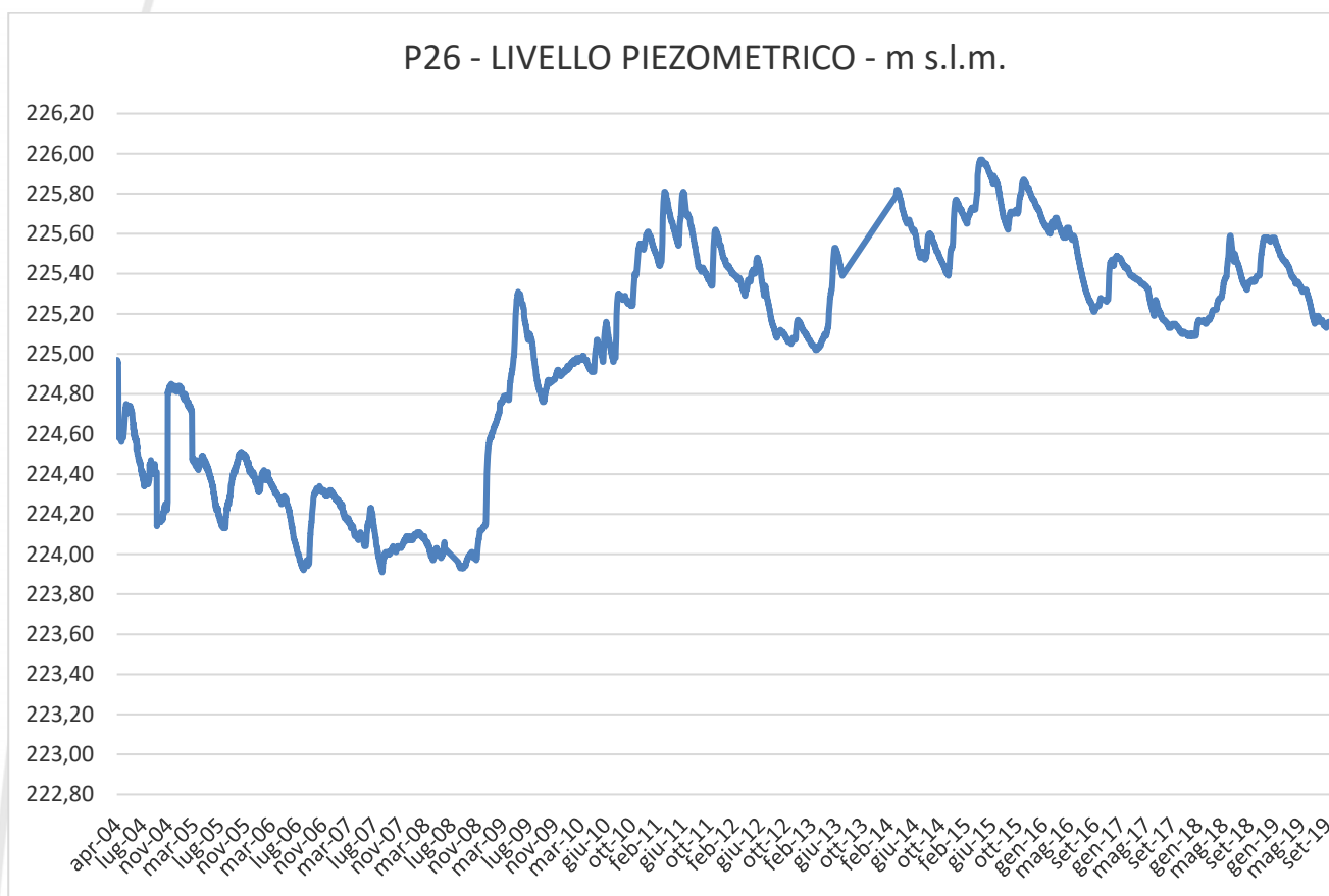
Figura h – Andamento del livello piezometrico relativo alla falda superficiale nel piezometro P26 (Rete di monitoraggio delle acque sotterranee della Regione Piemonte - Direzione Pianificazione Risorse idriche sotterranee)
