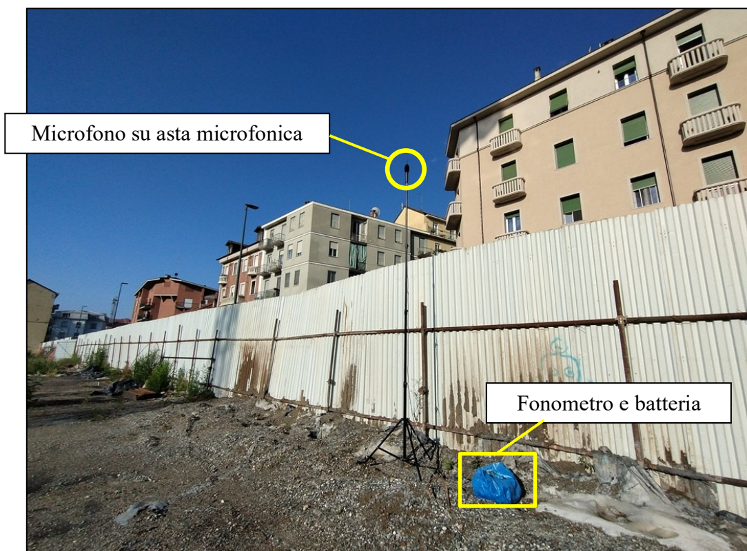
Fig. 8 – Fonometro in misura lato Strada Basse di Dora vista da interno area
