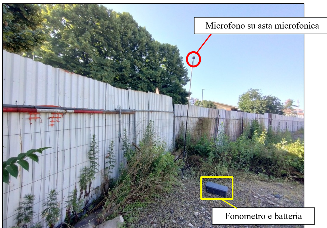
Fig. 10 – Fonometro in misura lato Via L. Bellardi vista da interno area
