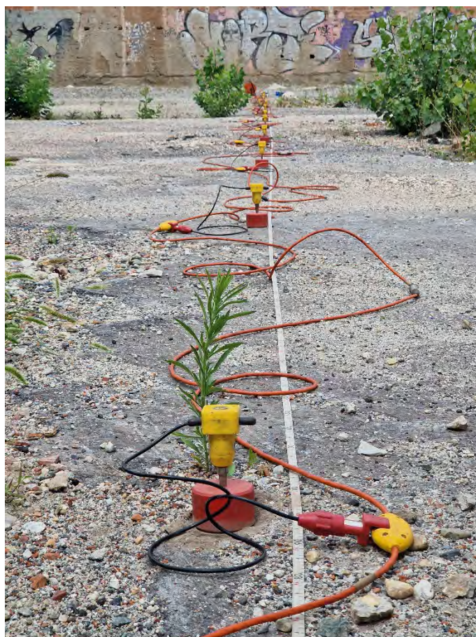
Foto n.2 – particolare sensori e stendimento geofisico
