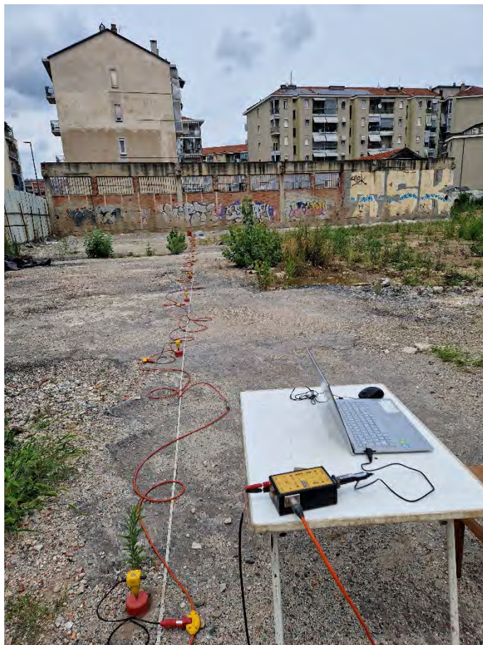
Foto n.1 – panoramica stendimento geofisico MASW
