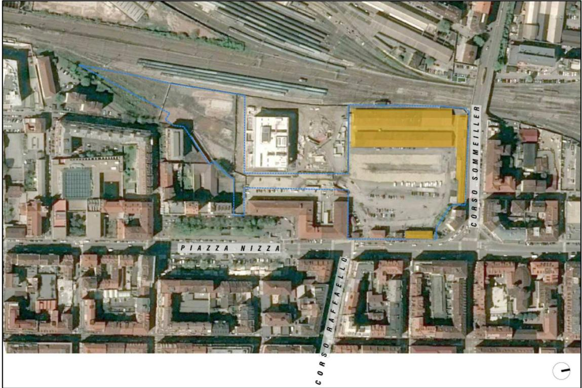
Figura 2.2 - Perimetro del Piano Esecutivo Convenzionato (in blu) e gli edifici oggetto di demolizione (in giallo)
