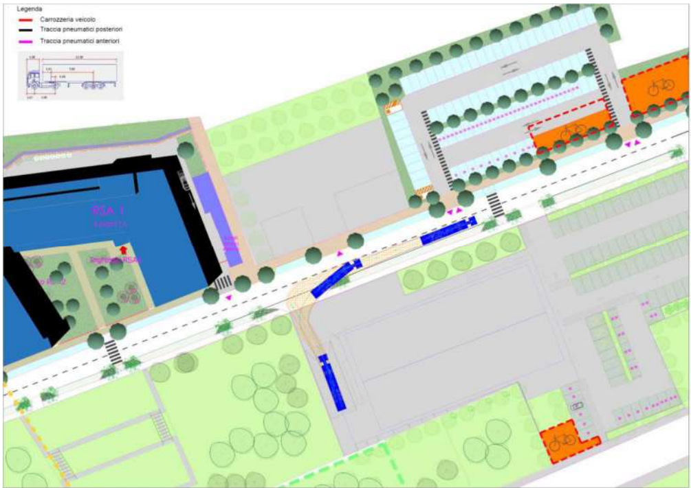
Figura 33.1: Accessibilità in uscita all'area carico-scarico merci (particolare)
