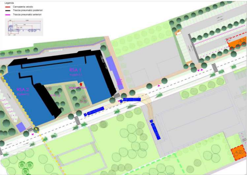
Figura 33: Accessibilità in uscita all'area carico-scarico merci (particolare)
