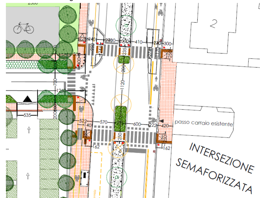
Figura 10 – Nuova intersezione su via Lanzo
