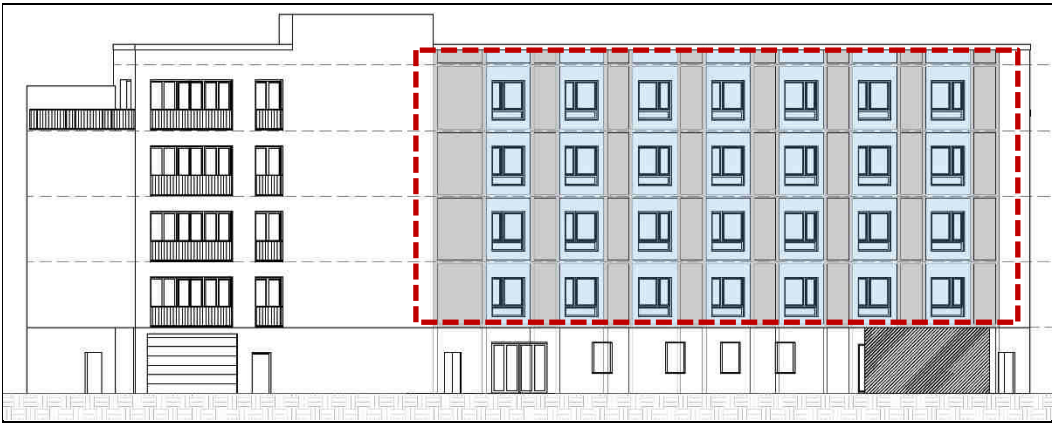
Figura 28. Prospetto ovest: inserimento barriera in vetro su locali camere
