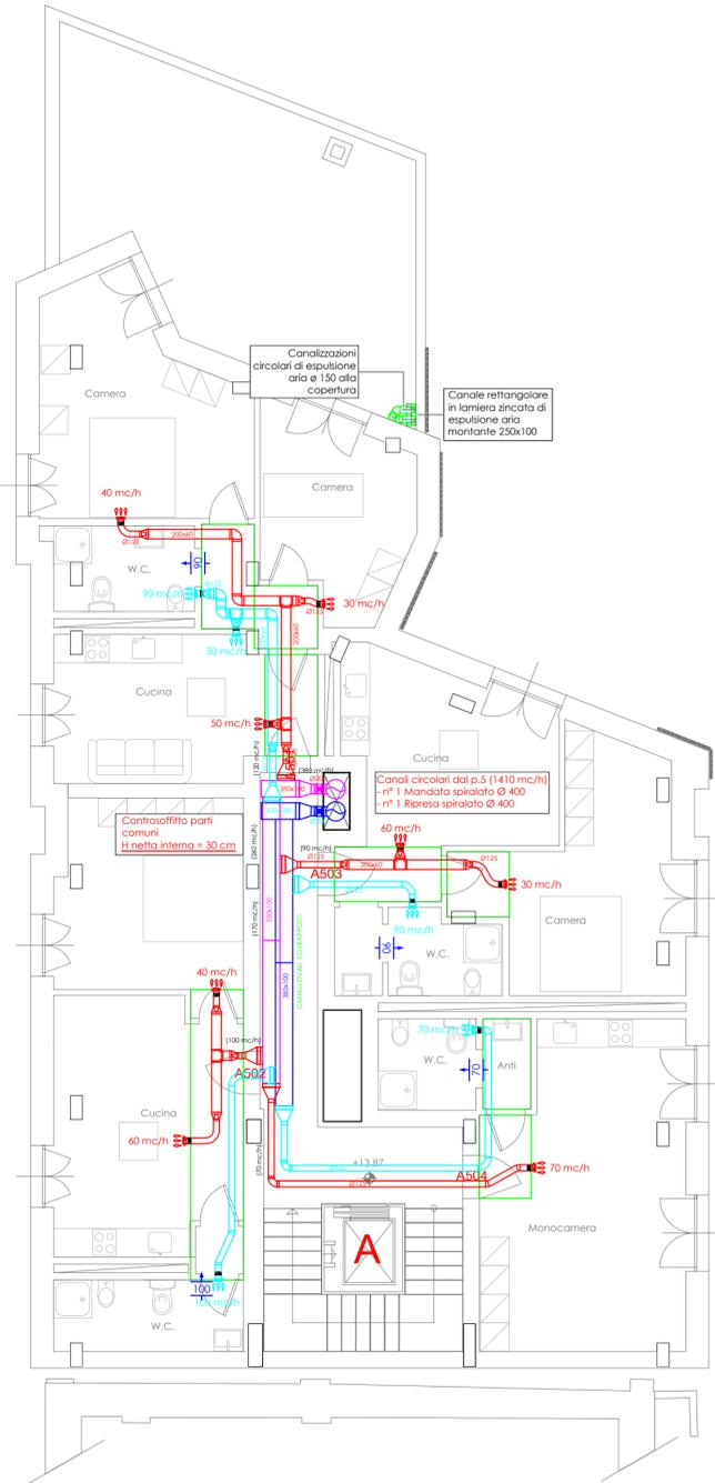
PIANTA PIANO QUARTO - SCALA B - IMPIANTO TRATTAMENTO ARIA VMC
