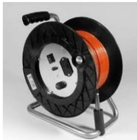
Figura 27: strumenti usati per: sx) le misure topografiche del piano campagna in corrispondenza dei piezometri e dei pozzi; dx) le misure freatiche manuali
