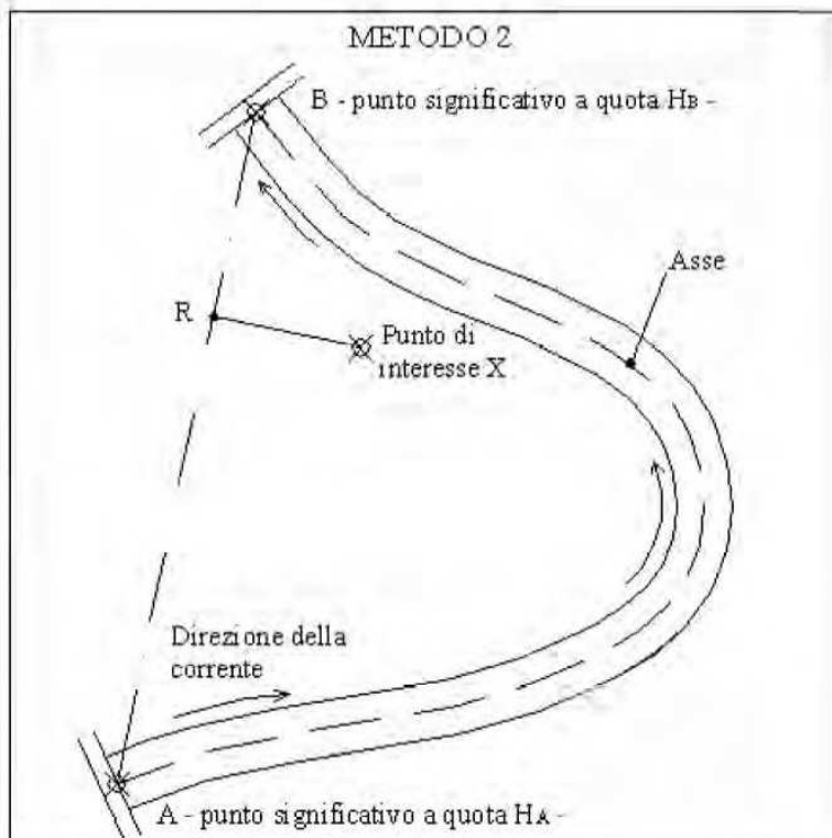
Grafico 3: Esempio di applicazione per il calcolo della quota di riferimento in corrispondenza del punto di interesse X utilizzando il METODO 2.
