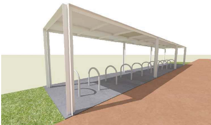
Figura 36 - Copertura delle rastrelliere
