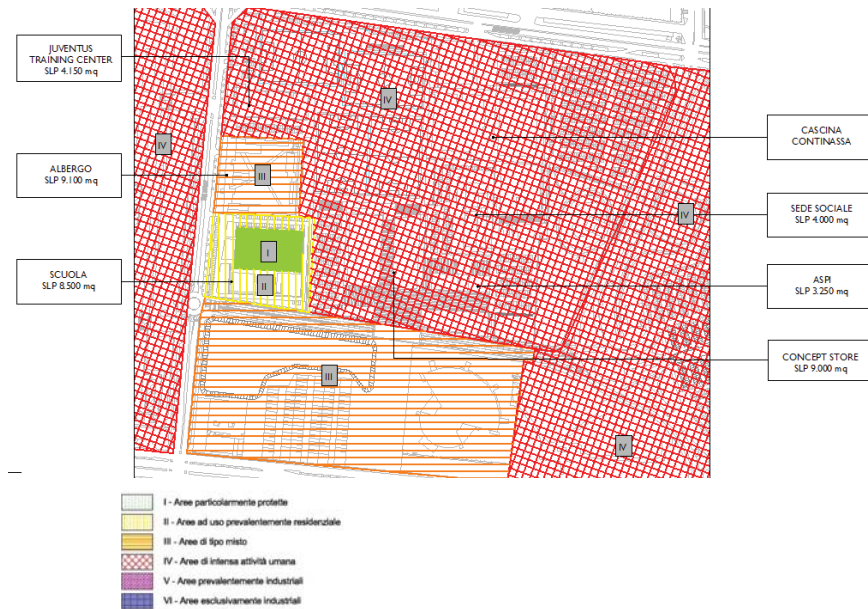
Figura 3.2.1 – Stralcio della Proposta di Variante al Piano di Classificazione Acustica FASE II
