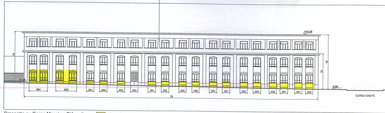
Prospetto su Corso Massimo D'Azeglio ■ demolizioni
